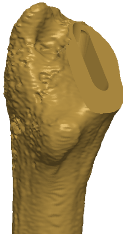
Obr. 32: Model femuru pre totálnu endoprotézu
