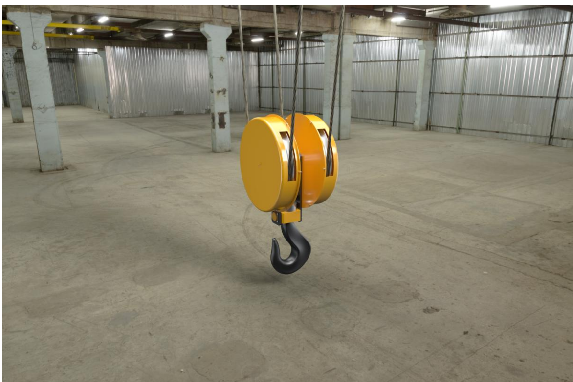
Obr. 4-10 Vizualizace jeřábové kladnice se statickým pozadím, CPU rendering.
