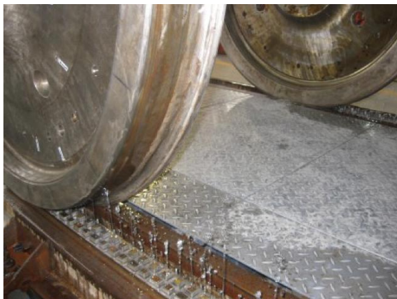
Obr. 3-17 Ultrazvukové sondy umístěné v kolejnici [16]
