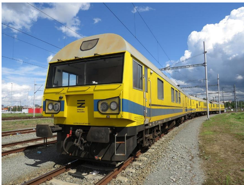
Obr. 3-31 Diagnostická jednotka pro nedestruktivní zkoušení kolejnic [37]
