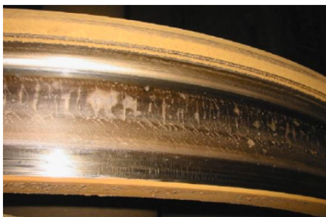
Obr. 3-10 Trhлина v důsledku brzdění na jízdní ploše [10]
