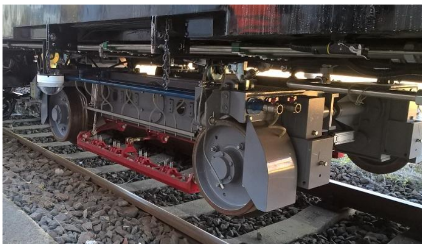
Obr. 3-32 Měřicí podvozek k zajištění diagnostického zařízení [37]
