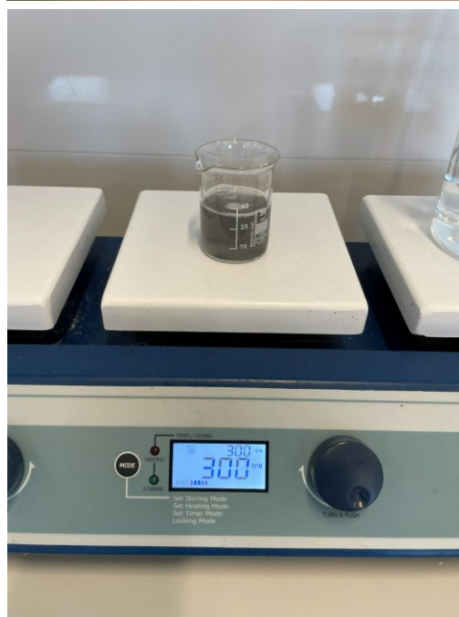
Obr. 4-4 Postup prípravy koncentrovaného roztoku \text{WS}_2 v SK. Obrázky popisujú nasledovné úkony: váženie fullerenov; miešanie silne koncentrovaného materského roztoku; ultrasonikácia materského roztoku; miešanie koncentrovaného roztoku \text{WS}_2 v SK.
