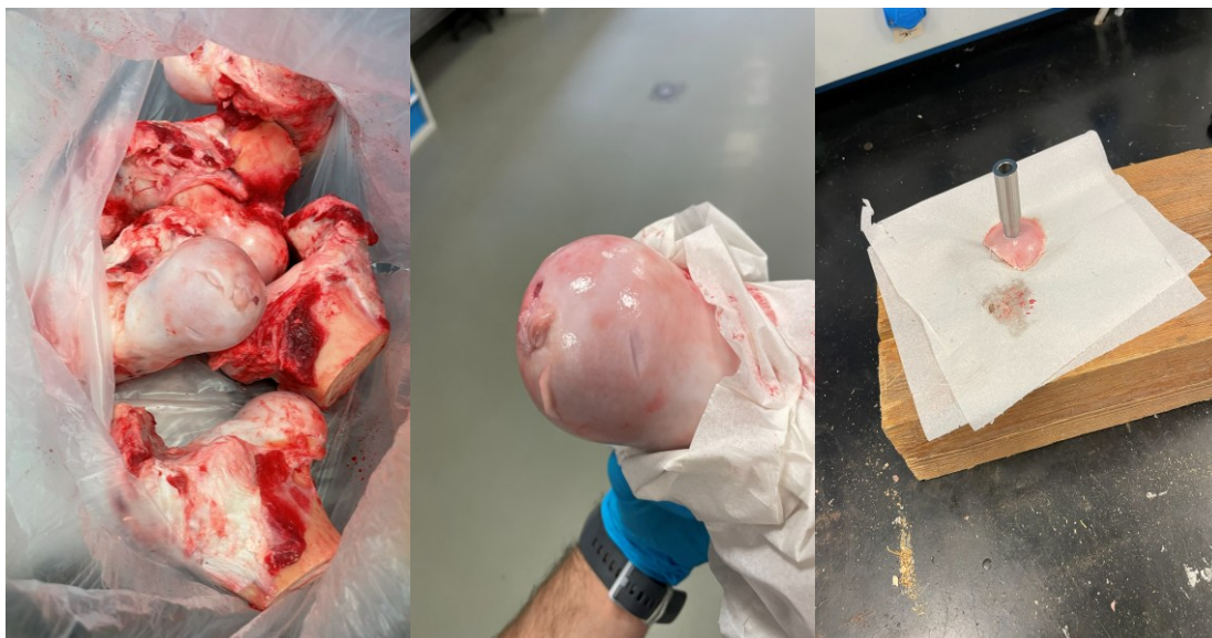
Obr. 4-3 Príprava pinov z natívnej hovädzej chrupavky.
