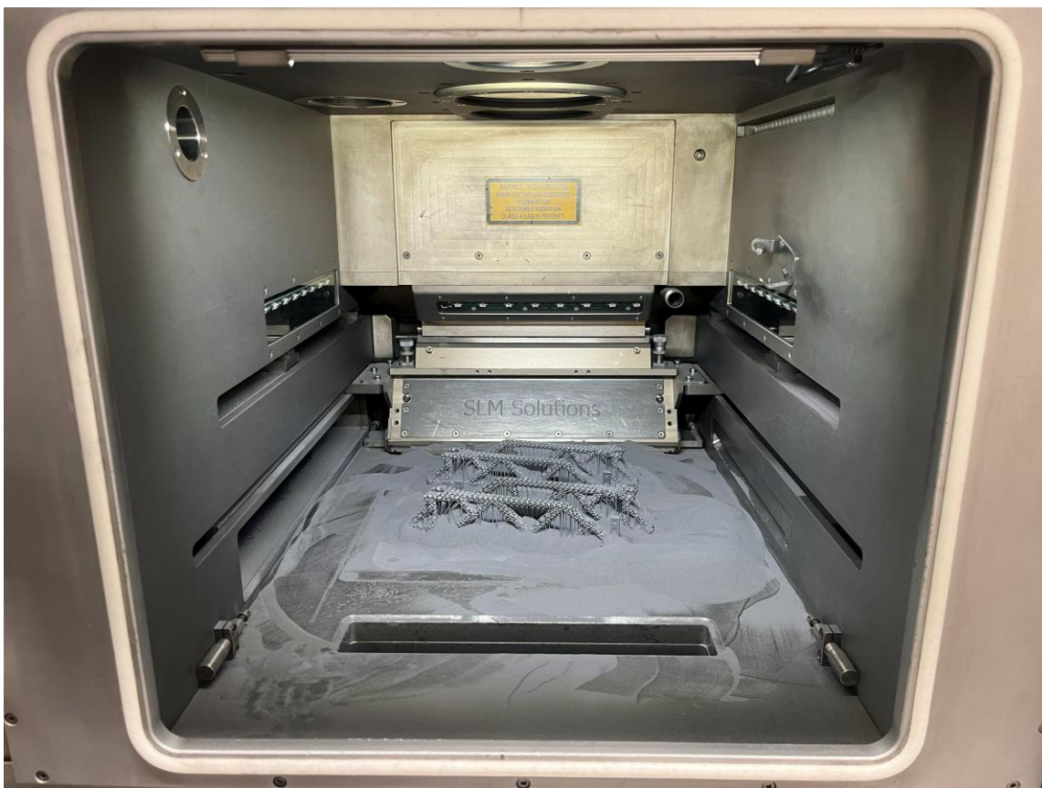
Vyrobená finální ramena stále uvnitř komory SLM 280 HL
