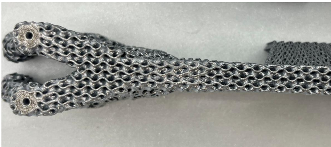
Obr. 5-2 Detail modifikované tloušťky struktury na finálním vyrobeném rameni dronu
