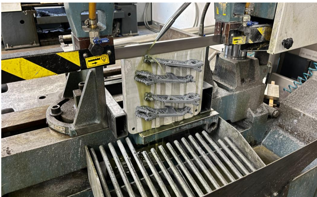
Odřezávání ramen z výrobní platformy na pásové pile s přívodem chladicí kapaliny
