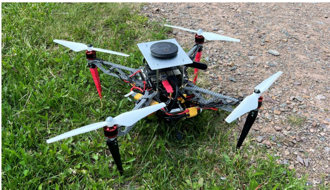
Obr. 5-7 Dron s Topologicky optimalizovanými rameny vyrobenými L-PBF technologií za využití Gyroid lattice struktury
