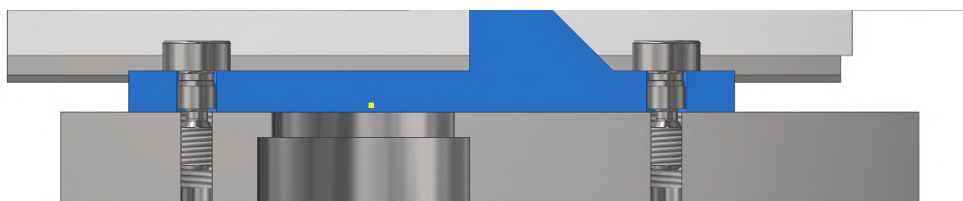
Obrázek 44 - Detail uchycení ramene k přírubě modulu
