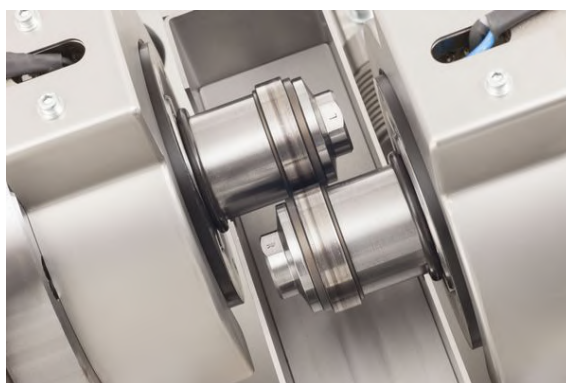
Obrázek 9 - Twin-disc tribometr s válcovými disky [35]
