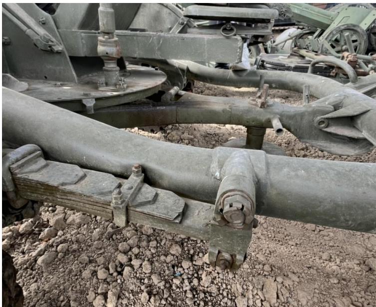
Obr. 3.2: Listové pružiny podvozku
