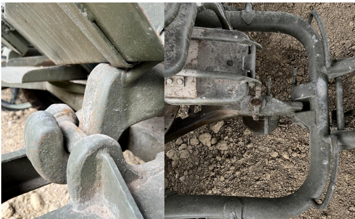
Obr. 3.1: Nosné prvky lafety
