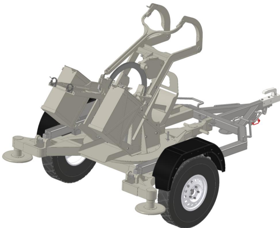
Obr. 7.1: ZPU-2 s modernizovaným podvozkom
