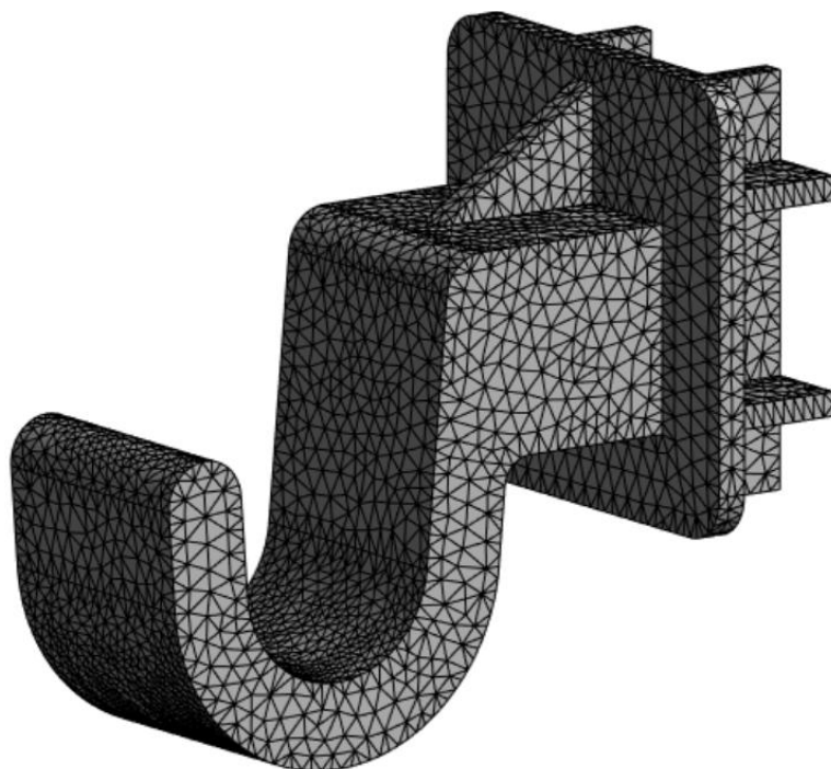
Obr. 5.12: Sieť MKP závesného háku obsahuje 45288 uzlov a 25649 elementov, elementov s veľkosťou 2 mm.
