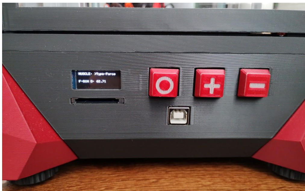
Obrázek 13 - Ovládací panel měřicí stanice
