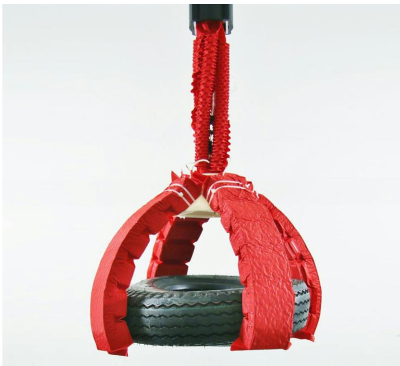
Obrázek 3 – Podtlakový chapadlový manipulátor využívající podtlakové FOAM svaly, převzato z [16]
