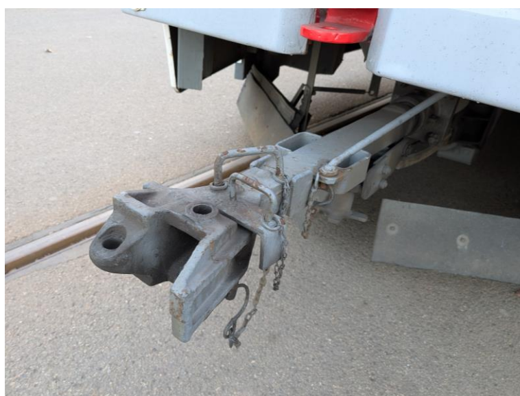
Obr. 69 příklad spřáhla typu Atlas (nebo též spřáhlo pražského vzoru) (zdroj: autor)
