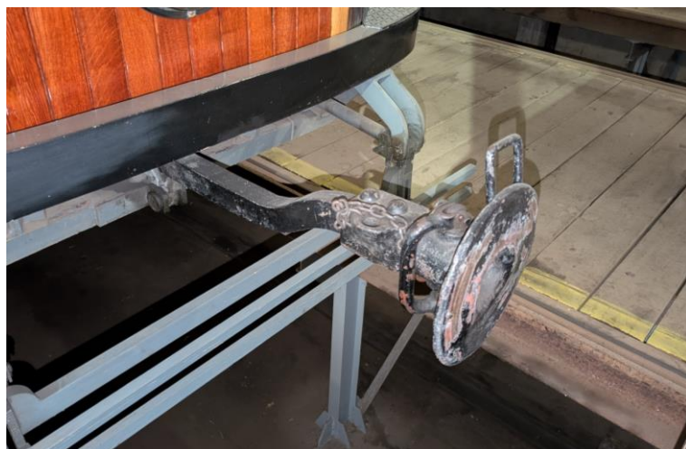
Obr. 68 příklad talířového spřáhla (zdroj: autor)
