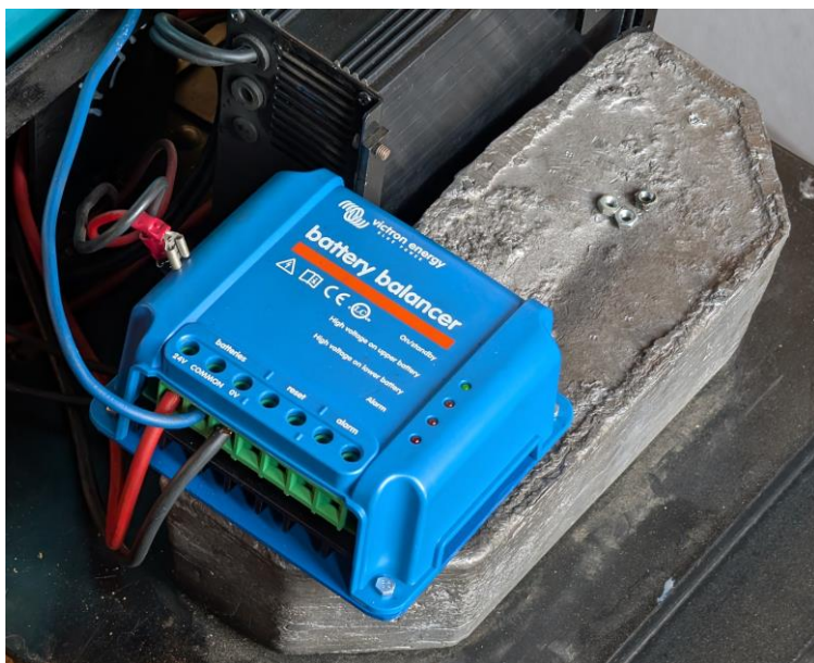
Obr. 40 bateriový balancér umístěný na předním olověném závaží (zdroj: autor)
