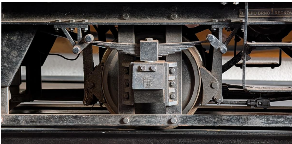
Obr. 13 vypružení a vedení nápravy lokomotivy AEG (zdroj: autor)
