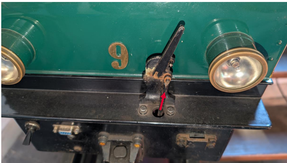
Obr. 15 Ovládací páka brzdy na zadní straně lokomotivy (zdroj: autor)
