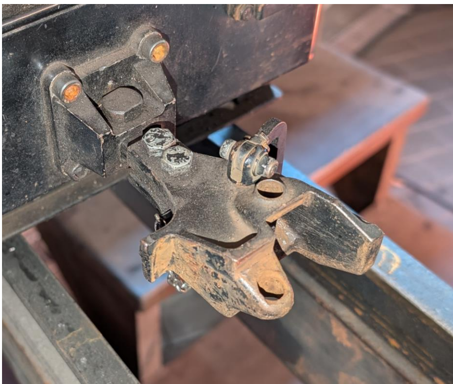
Obr. 35 praktické provedení spřáhlového ústrojí na lokomotivě č.9 (zdroj: autor)
