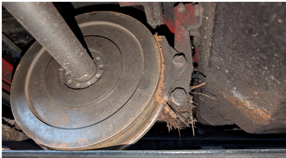
Obr. 54 Provedení špalíkové brzdy na lokomotivě LT12 (zdroj: autor)
