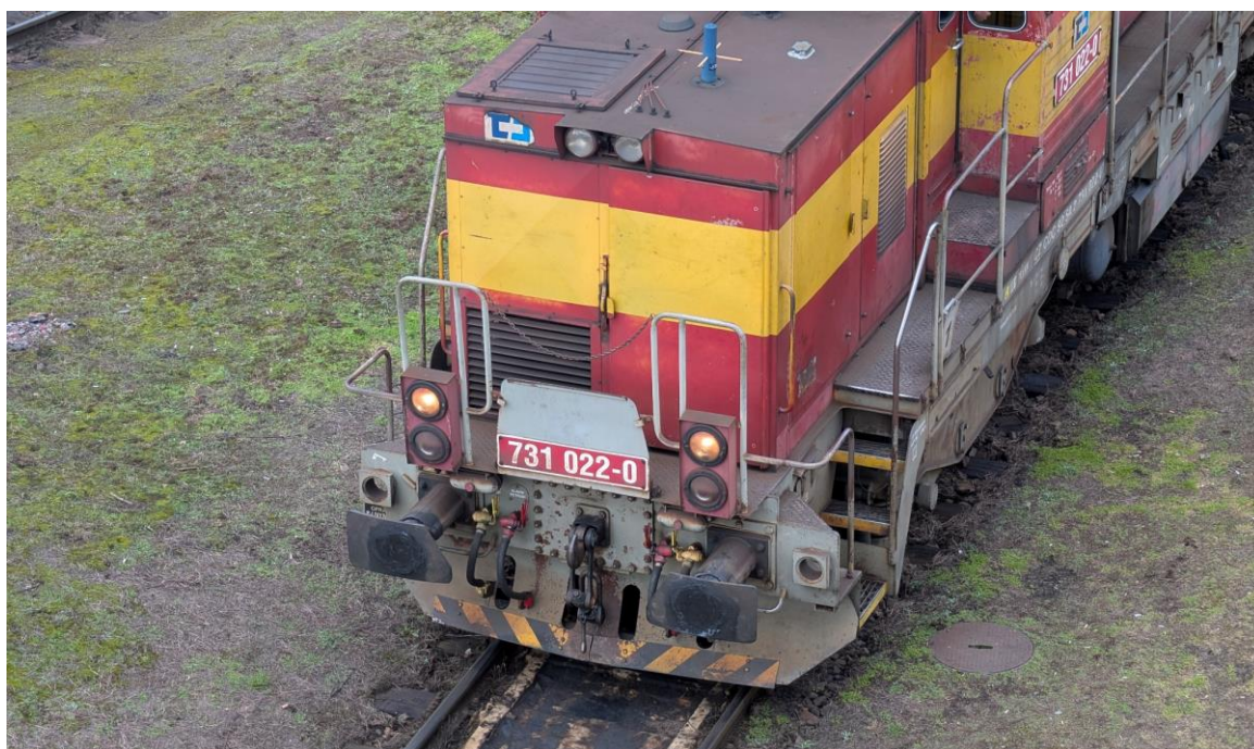
Obr. 67 lokomotiva s táhlovým ústrojím a nárazníky (zdroj: autor)
