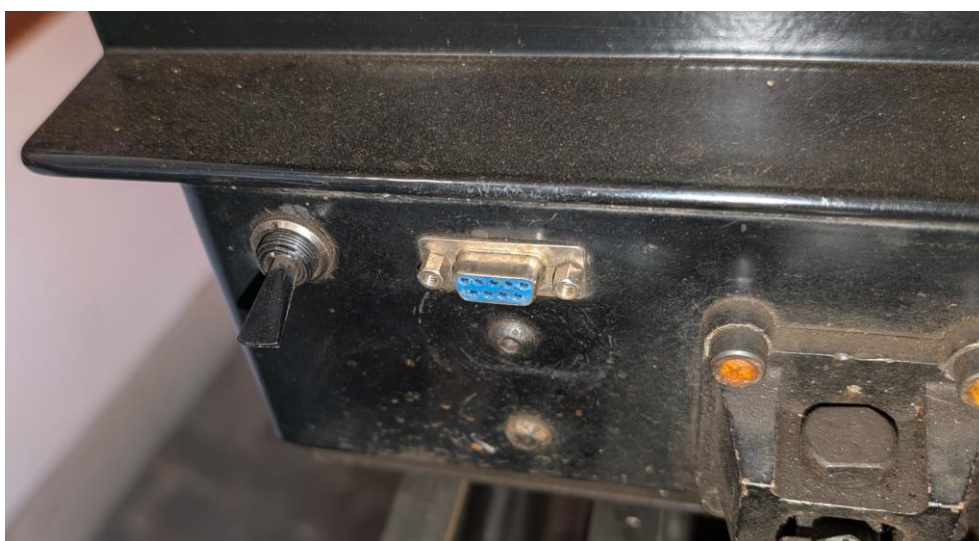
Obr. 36 konektoru dálkového řízení (vpravo) a vypínač předních reflektorů (vlevo) (zdroj: autor)
