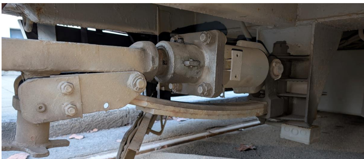
Obr. 70 uložení a vypružení spřáhla tramvaje typu KT8D5R.N2 (zdroj: autor)
