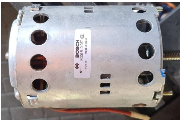
Obr. 25 elektromotor BOSCH F006 B10 267 (zdroj: autor)
