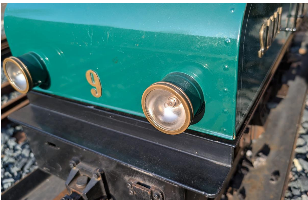
Obr. 33 detail reflektoru na čele lokomotivy (zdroj: autor)
