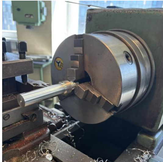
Obrázek 5-3 Fotka výroby osy na soustruhu
