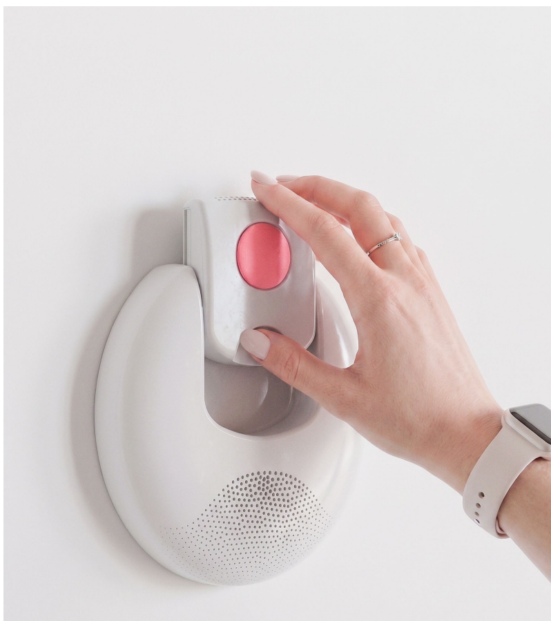
Obr. 6-10 Vizualizace vyjmutí mobilní části ze stacionární
