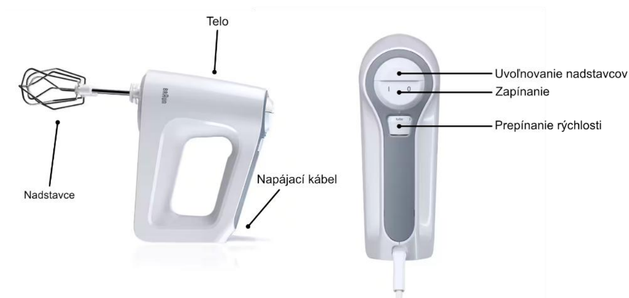
Obr. 2-26 Schéma častí ručného mixéra [13]
