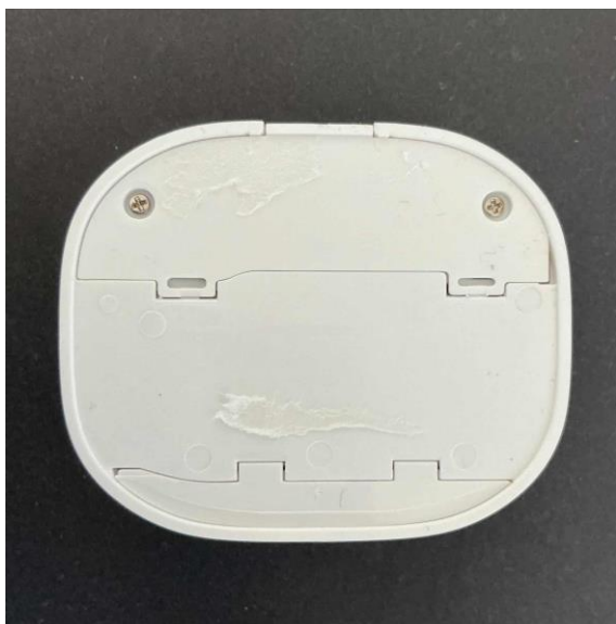
Obr. 2-10 TrueLife SonicBrush UV Sterilizer ztržený protiskluzový prvek
