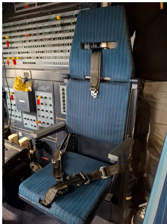
Obr. 2-6: Fotografie skládací sedačky – Airbus A320
