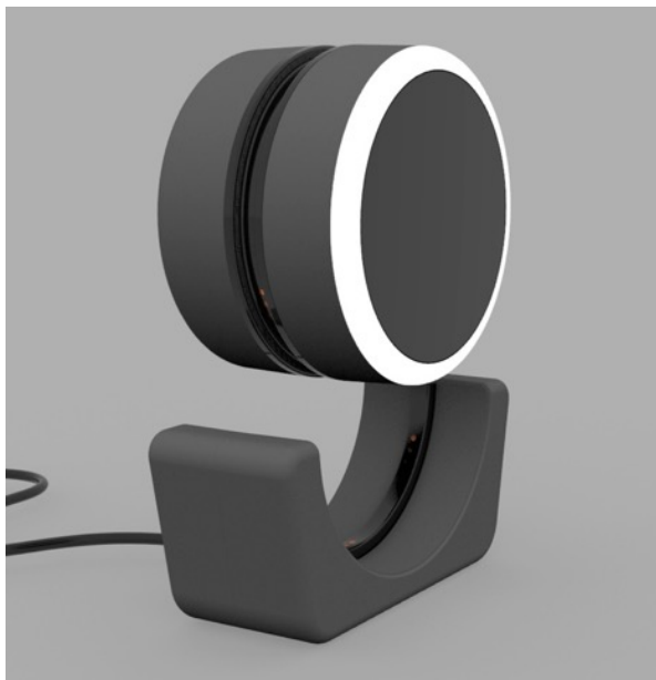
Obr. 6-5 Uložení budíku v dokovací stanici pomocí magnetických konektorů
