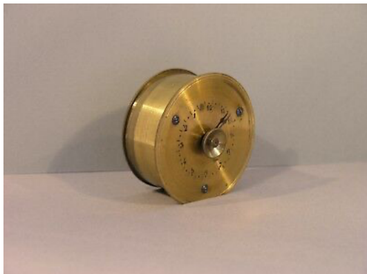
Obr. 2-7 Patent Antoine Rediera (1847) – první nastavitelný mechanický budík [12]
