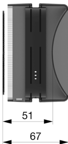
Obr. 6-20 Řez korpusu zobrazující ergonomické zahlobení
