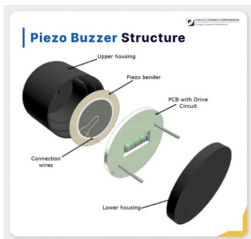
Obr. 2-26 Konstrukce piezoelektrického bzučáku – keramický disk, elektrody, rezonanční komora [40]
