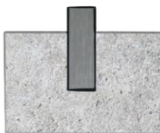
zapuštění do betonového základu
