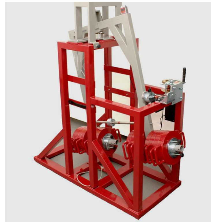
Konstrukce simulátoru kyčelního kloubu
